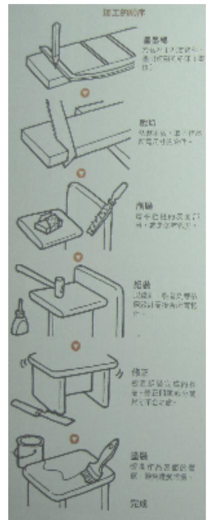
可事先利用略小於鐵釘孔徑的電鑽鑽出「預鑿孔」。再者，若能同時使用黏著劑(如木工白膠)，以讓作品接合得更加牢固。
