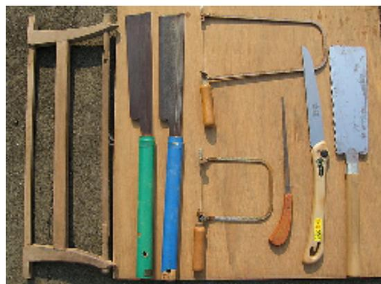
4· 線鋸：可以鋸切較寬的木板或鋸切曲線用，可更換（如圖中右四）
