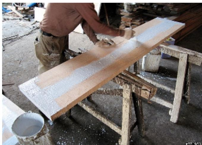
封漆：原木是富含水份，將毛料製材完成後，馬上需要面對的就是~龜裂~，製材完成後面對大氣中的溼度、熱度是造成~龜裂~的主因之一。所以會使用~白臘~塗上毛料的斷面與容易龜裂的紋路上，稱為封
